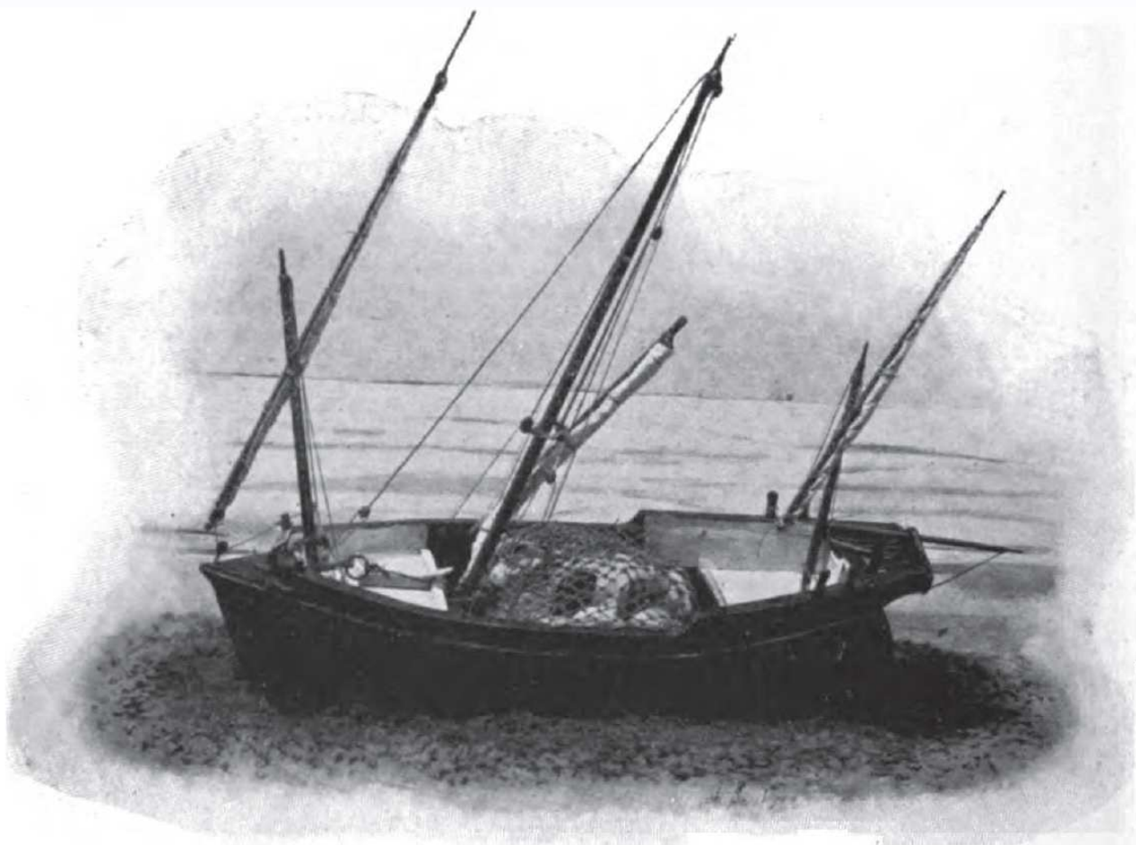
Carèbe tunisien — Longueur, 15m; largeur, 5m; creux, 1 m 50
